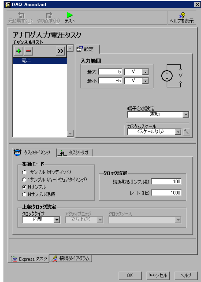
図 4-1 DAQ アシスタントを使用してタスクを構成する
