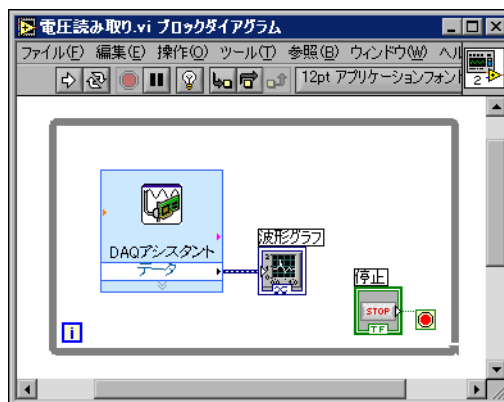
図 4-2 電圧読み取り VI のブロックダイアグラム
